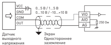
Рисунок 5 – Подключение аналоговых входов (входной сигнал – напряжение)
