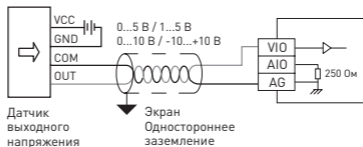
Рисунок 5 – Подключение аналоговых входов (входной сигнал – напряжение)
