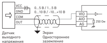
Рисунок 4 – Подключение аналоговых входов (входной сигнал – напряжение)
