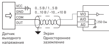
Рисунок 4 – Подключение аналоговых входов (входной сигнал – напряжение)
