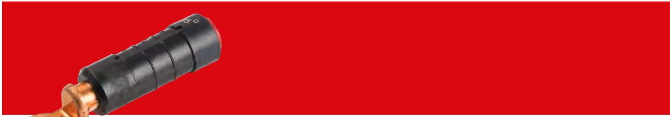
Герметичные изолированные алюмомедные наконечники СРТАУ необходимы для герметичного оконцевания многожильных алюминиевых и медных проводов опрессовкой. Внутренняя алюминиевая часть заполнена контактной смазкой, предохраняющей алюминий от окисления, снижающей контактное сопротивление, а также обеспечивает надежный электрический контакт в системе медь – алюминий.
