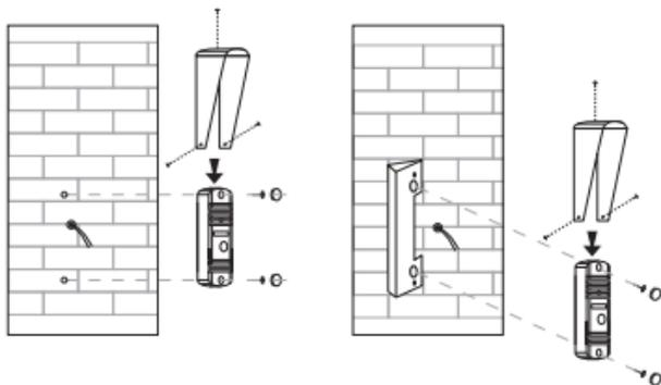
Рис. 1 - Схема установки CPV-01 / CPA-01
