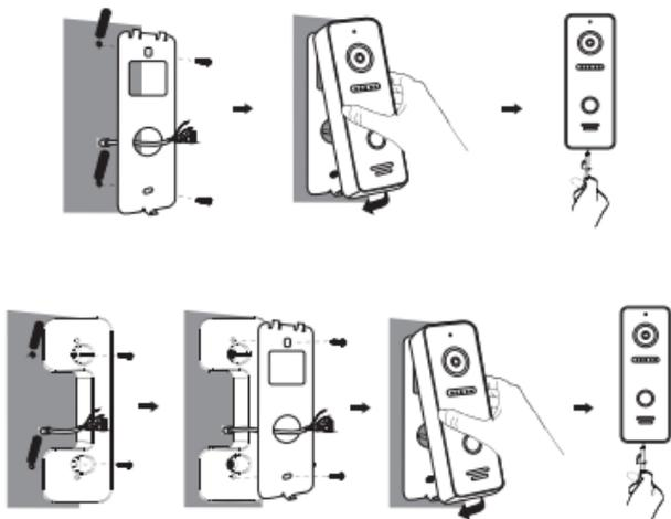
Рис. 2 - Схема установки CPV-02 (с кронштейном и без)
