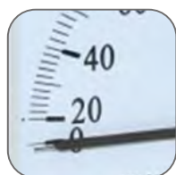
Настройка нулевого положения стрелки
