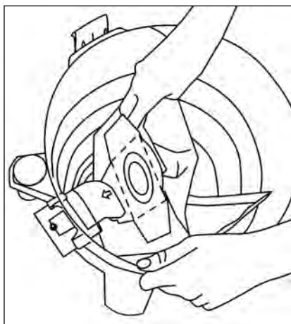
Рис. 6 Установка мешка для сбора пыли
