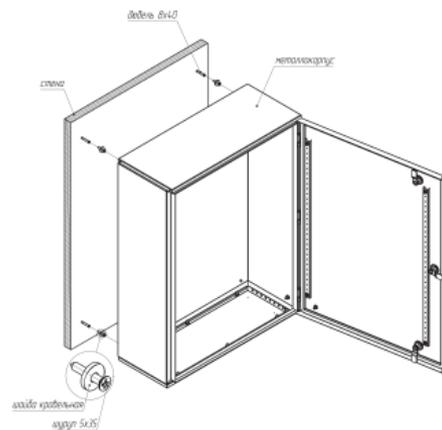
Рис. 1.1. Схема настенного монтажа.
