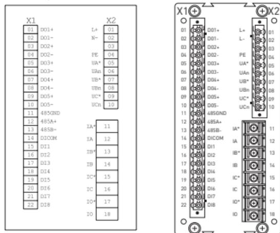
Рис. 2 – Расположение клемм
