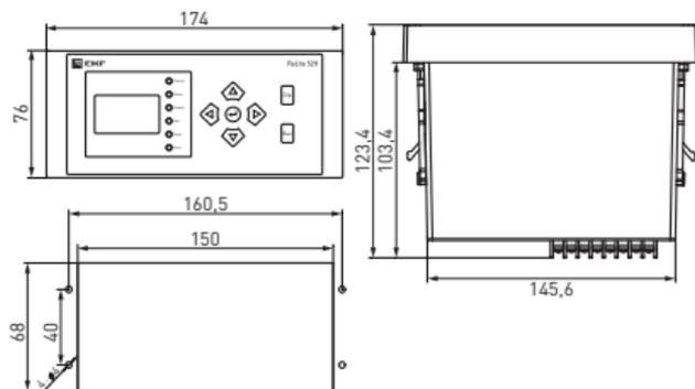
Рис. 4 – Габаритные размеры устройства ReLite 52 в горизонтальном исполнении
