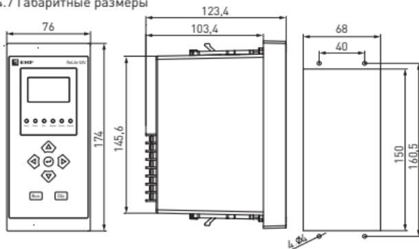
Рис. 3 – Габаритные размеры устройства ReLite 52 в вертикальном исполнении
