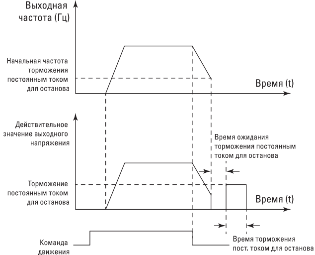
Рис. 6-13. Схема торможения постоянным током для останова
