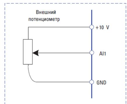
Дополнительно, необходимо учитывать различные параметры минимального сигнала для входов по току и по напряжению. При работе по напряжению значение F5-13 = 0, при работе по току F5-13 = 2 (по умолчанию для датчика 4-20 мА) для аналогового входа AI1. Если планируется работа по сигналу у которого границы отличаются от стандартных 4-20 мА / 1-10 В, то для параметров F5-13 (минимальное значение) и F5-15 (максимальное значение) каждая единица параметра равняется либо 1В, либо 2мА.
