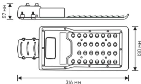
Рис. 1 - Габаритные размеры светильника ДКУ-9001-Ш
