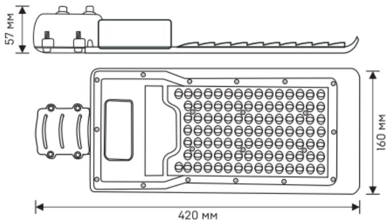
Рис. 3 - Габаритные размеры светильника ДКУ-9003-Ш
