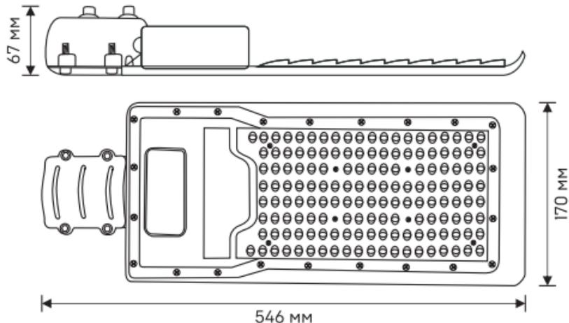
Рис. 4 - Габаритные размеры светильника ДКУ-9004-Ш
