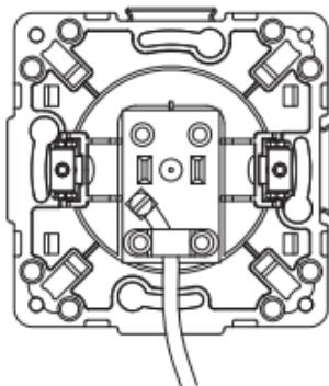
Подсоединить провода, подсунув зачищенные концы в пазы контактных зажимов.
