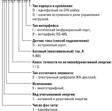
Рисунок 1 - Структура условного обозначения счётчиков SKAT 115
