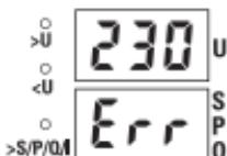
Рис. 6 Отображение ошибки на дисплее
