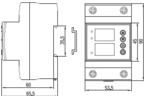
Рис. 8 Габаритные и установочные размеры
