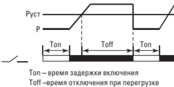
Рис. 2 Диаграмма работы реле при превышении установленной мощности
