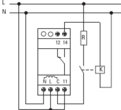
Рис. 5 Нагрузка с потребляемой мощностью более 2 кВт, требуется применение контактора
