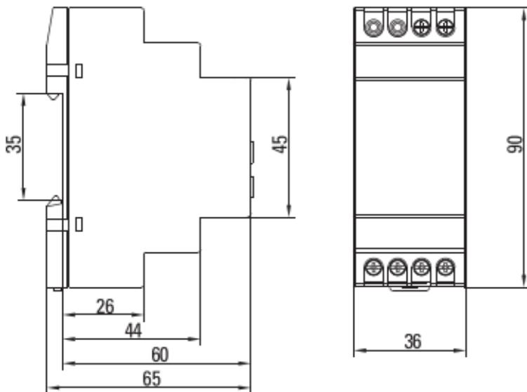
Рис. 3 Габаритные и установочные размеры
