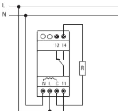
Рис. 4 Нагрузка с потребляемой мощностью не более 2 кВт
