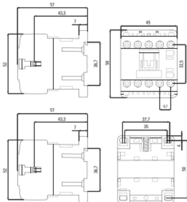
Рис. 1 Габаритные размеры МК3 EKF PROxima
