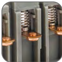
Самопозиционирующиеся подвижные контакты. Они могут качаться, подпружинены и имеют сферическую поверхность. Мостиковый контакт создает условия для быстрого гашения дуги
