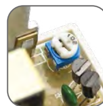
Возможность корректировки выходного напряжения
