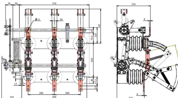
Рисунок 1 – Габаритные размеры VNA(l)-10/630-20-Iz UHL2 EKF Stingray
