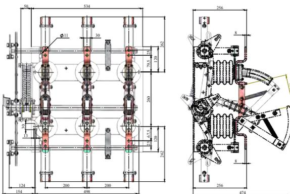
Рисунок 3 – Габаритные размеры VNA(l)-10/630-20-IIIz UHL2 EKF Stingray
