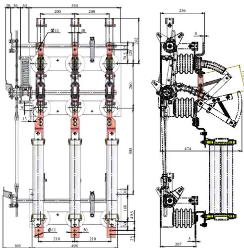
Рисунок 4 – Габаритные размеры ВНА(л)-10/630-20-III-PT1.2 УХЛ2 ЕКФ Stingray
