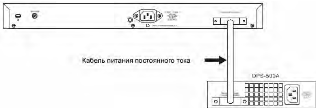
Рисунок 10 — Подключение DPS-500A к коммутатору
