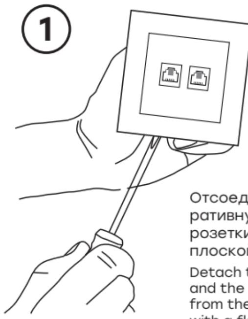
Отсоединить крышку и декоративную рамку от корпуса розетки, поддев наконечником плоской отвертки.
