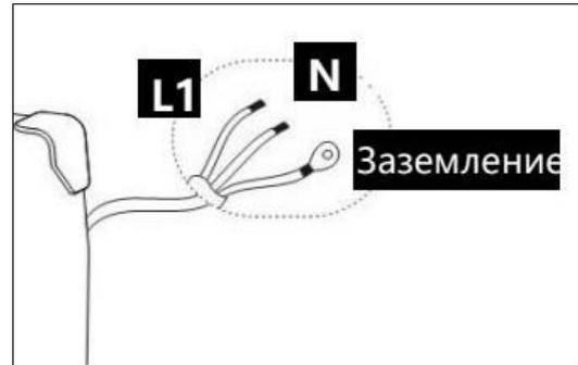
Подключите аппарат к однофазной сети напряжением 230 В согласно рисунку, где
