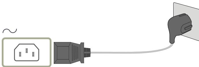
Для работы с устройством подключите кабель питания к электрической розетке и порту  $\sim$  (POWER IN) на устройстве.
