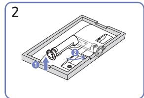
Вставьте соединительный элемент подставки в корпус в направлении стрелки, как показано на рисунке. Крепко закрутите соединительный винт в нижней части подставки.
