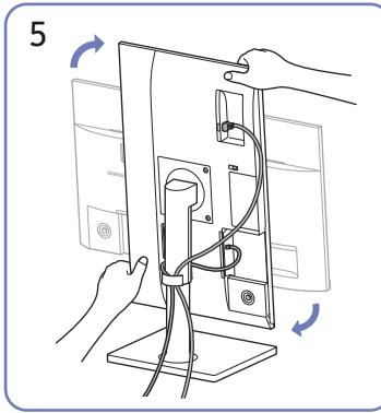
Поверните устройство в горизонтальное положение.
