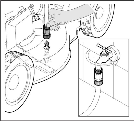
**ВНИМАНИЕ!** Запрещается поднимать косилку над поверхностью земли или включать привод колес во время произведения мокрой очистки корпуса. Брызги воды могут попасть в двигатель или лезвия могут повредить шланг.
