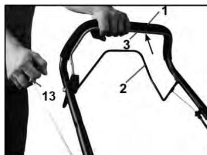
Прижмите рычаг остановки двигателя (3) к рукоятке и, удерживая его, энергично потяните за ручку стартера (9). Не позволяйте ручке стартера отскочить назад (отскакивая, она может повредиться сама и повредить стартер).
