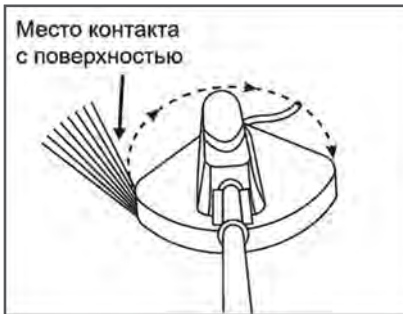
Рис. 9 Место контакта триммерной головки с поверхностью при удалении растительного покрова и обработке границы газона
