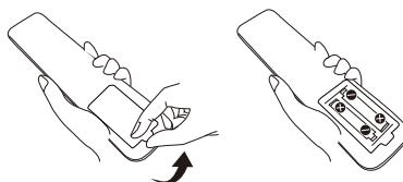
Замените батарею, когда ее напряжение снизилось, ограничивая область действия ПДУ. Не используйте вместе батареи разных типов (например, марганцевые и щелочные). Следует утилизировать батареи с учетом соответствующих норм по защите окружающей среды.
