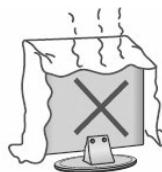
устанавливайте телевизионный приемник непосредственно на других предметах, которые выделяют тепло: например, видеоплеерах и аудиоусилителях. Не закрывайте вентиляционные отверстия на задней крышке. Вентиляция необходима для предотвращения отказа электрических компонентов. Не сдавливайте шнур питания под основным блоком или другими тяжелыми предметами.
