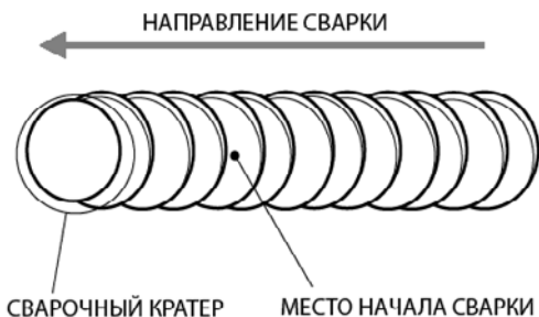
Рис. 11.6. Начало сварки при смене электрода.
