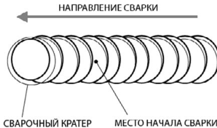
Рис. 11.5. Начало сварки при смене электрода.
