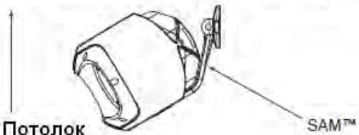
Рисунок 7. SAM установлен снизу
