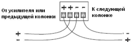
Рисунок 13. Последовательное подключение
