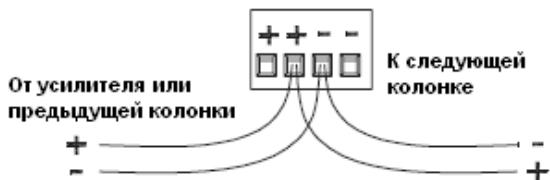
Рисунок 12. Паралельное подключение
