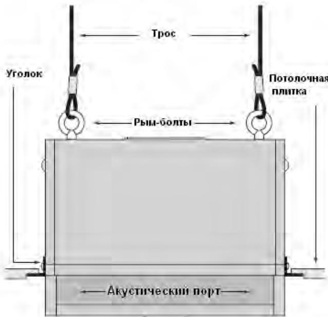
Рисунок 26. Установка уголков.
