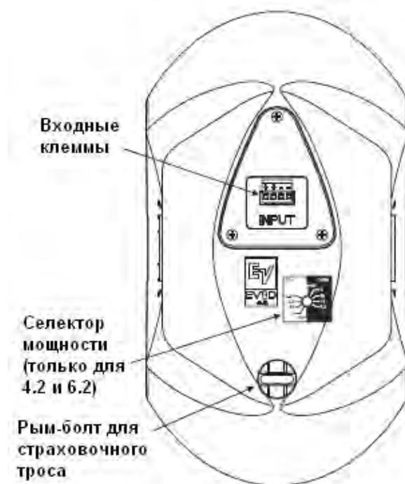
Рисунок 3. Вид сзади
