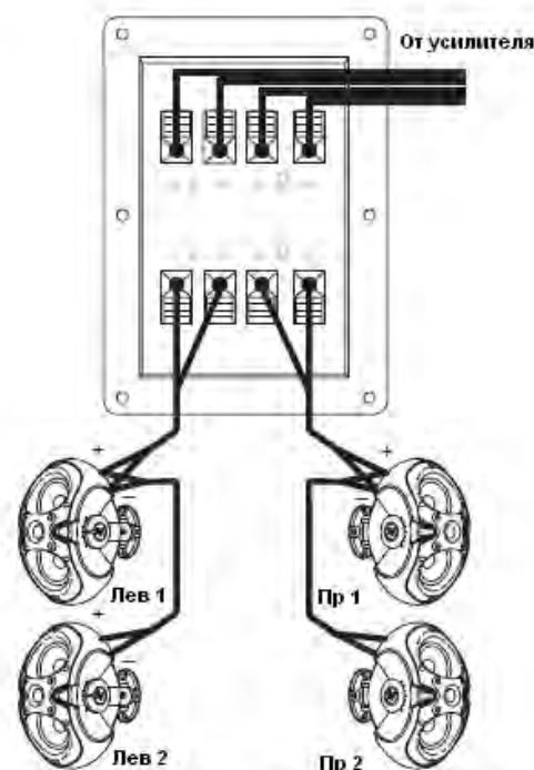
**Рисунок 23. Последовательное подключение**
