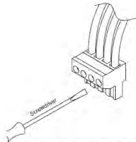
Рисунок 14. Затяните с помощью отвертки
