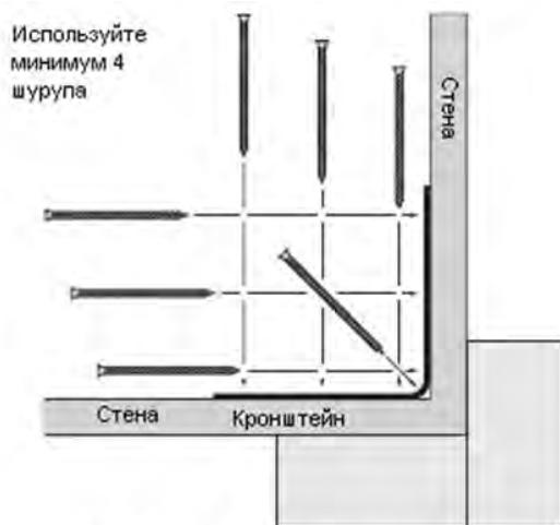
Рисунок 20. Установка в угол.
