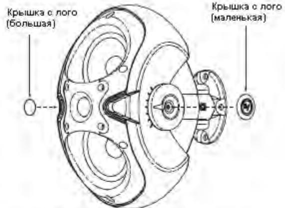
Рисунок 11. Закрепите крышки с логотипом
