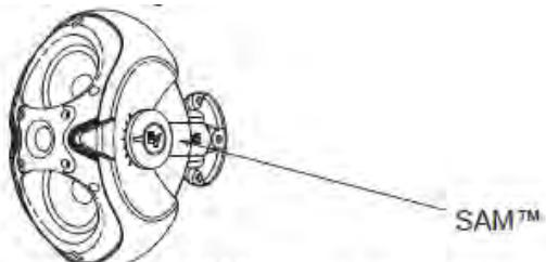
Рисунок 6. SAM установлен сбоку
