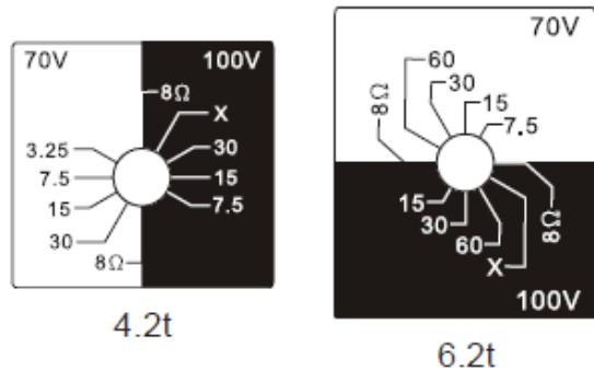
Рисунок 8. Переключатель мощности (EVID 4.2T и EVID 6.2T)
