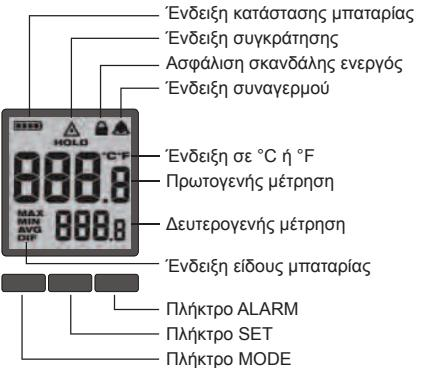
**ΥΠΟΔΕΙΞΗ:** Έντονες μεταβολές θερμοκρασίας (> 12 °C) μπορεί να έχουν επιπτώσεις στο αποτέλεσμα των μετρήσεων. Γι' αυτό να εξασφαλίζετε, να έχεις η συσκευή, μετά την ενεργοποίηση και πριν τη χρήση, μια σταθερή θερμοκρασία λειτουργίας. (Ανάλογα με τις περιβαλλοντικές συνθήκες μπορεί να διαρκέσει αυτό 5 έως 30 λεπτά).
