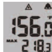
2. Ако задръжте спуска натиснат, появява се символът и се показват температурата на повърхността (първично измерване) и максималната температура (вторично измерване).
