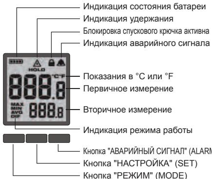
**УКАЗАНИЕ:** Сильные колебания температур (> 12 °C) могут повлиять на результат измерений. Поэтому убедитесь, что прибор после включения и до его использования достиг своей стабильной эксплуатационной температуры. (В зависимости от условия окружающей среды это может занять от 5 до 30 минут).
