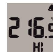
Per selezionare la scala di temperatura desiderata, attivare l'azionatore e premere tre volte il tasto SET. Con i tasti sopra le frecce selezionare °C o °F. Attendere 5 secondi fino a quando l'impostazione non sarà memorizzata, poi uscire dal menu.
