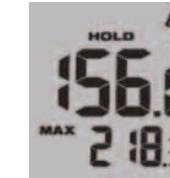
2. Якщо продовжувати утримувати спусковий гачок, з'явиться символ і відобразиться температура поверхні (первинне вимірювання) і максимальна температура (вторинне вимірювання).
