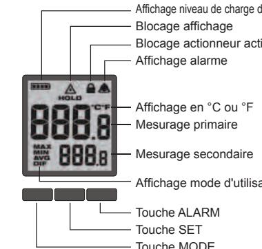
Pour sélectionner l'échelle de température souhaitée, activer l'actionneur et appuyer trois fois sur la touche SET. A l'aide des touches positionnées au dessus des flèches, sélectionner °C ou °F. Attendre 5 secondes jusqu'à la mémorisation de la configuration, ensuite sortir du menu.
