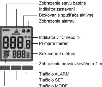
Na zvolenie želanej teplotnej stupnice stlačte spúšťač a trikrát stlačte tlačidlo SET. Pomocou tlačidiel zvolte cez šípkы °C a °F. Počkajte 5 sekund, až bude uložené nastavenie a opustite menu.
