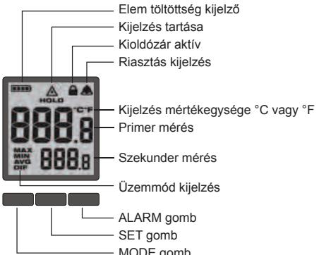
A kívánt hőméréséletet kijelző kiválasztásához nyomja meg a kioldót, és nyomja le háromszor a SET gombot. A nyílak feletti gombokkal válasszon az ON és az OFF beállítás között. Várjon 5 másodperct a beállítás eltárolásáig, majd lépj ki a menüből.
