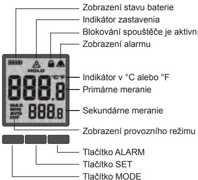
Pro zvolenie požadované teplotní stupnice stisknite spoušťe a trikrát stisknite tlačítko SET. Pomocí tlačitek zvolte pries šípky ON a OFF. Počkejte 5 sekund, až bude uložené nastavení a opusťte menu.
