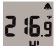
A kívánt hőméréséletet kijelző kiválasztásához nyomja meg a kioldót, és nyomja le háromszor a SET gombot. A nyílak feletti gombokkal válasszon a °C és a °F beállítás között. Várjon 5 másodperct a beállítás eltárolásáig, majd lépj ki a menüből.
