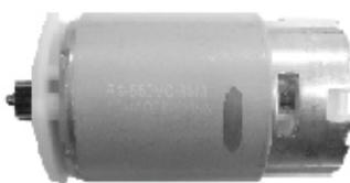
постоянного тока состоит из цилиндра, внутри которого располагаются постоянные магниты. Внутри цилиндра на втулках-опорах из латуни располагается якорь двигателя выполненный из электротехнической стали имеющая высокую магнитную проницаемость.
