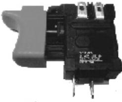
используется для запуска инструмента. Чем сильнее усилие нажатия на клавишу, тем быстрее скорость вращения инструмента, при отпускании клавиши движение инструмента прекращается.
