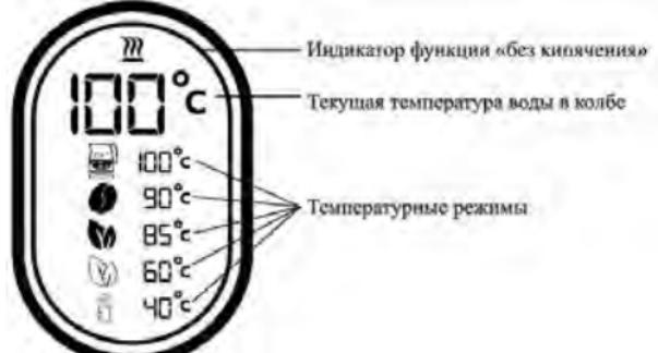
Чайник представляет собой емкость 1,5 л из термостойкого материала с носиком, ручкой и крышкой. Прибор укомплектован подставкой со шнуром питания для подключения к электросети. В верхней части крышки расположена кнопка открывания крышки чайника. В верхней части ручки располагаются кнопки управления чайником, на корпусе чайника находится LED дисплей.
