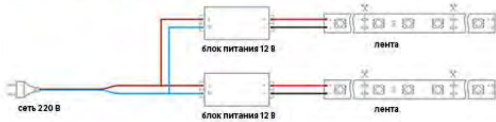
Параллельное подключение одноцветной ленты 12 В до 10 метров с двумя блоками питания
