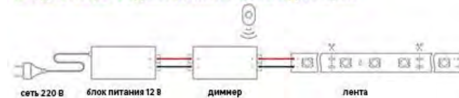
Последовательное подключение одноцветной ленты 12 В до 5 метров с одним блоком питания и диммером
