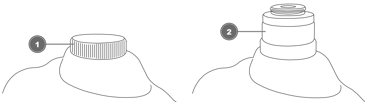
Рис. 5: Третья окулярная трубка и установленный фотоадаптер
