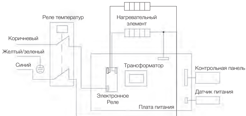
Схема электрических соединений для EWH Formax DL
