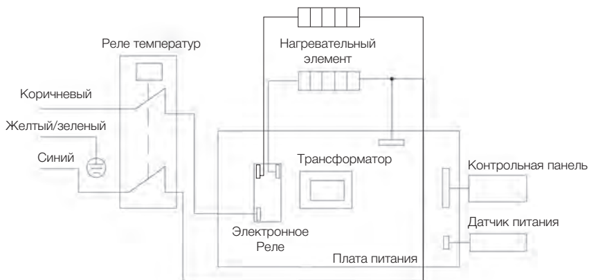
Схема электрических соединений для EWH Formax DL
