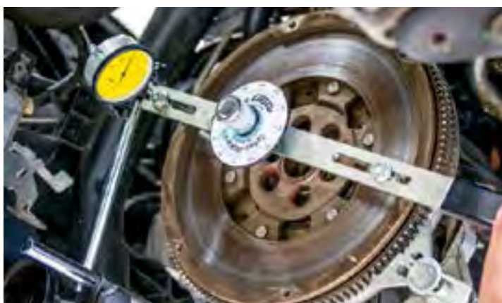
DMF специальный инструмент, номер для заказа: 400 0080 10
