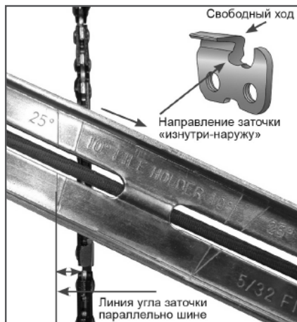
Рис. 18 Определение угла заточки
