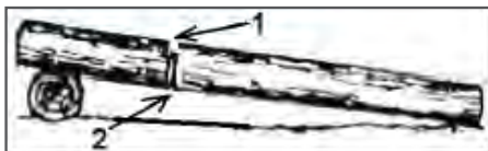
Рис. 14. Пропилы при раскряжевке дерева на одной опоре
