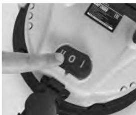
7.5 Данная модель пылесоса оснащена функцией полуавтоматической очистки НЕРА-фильтра. Для очистки фильтра переведите выключатель пылесоса в положение 0 и 3-4 раза нажмите на кнопку (14). В случае чрезмерного загрязнения фильтра его следует заменить на новый.
