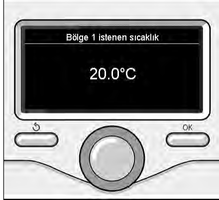
Oda sıcaklığının değiştirilmesi
