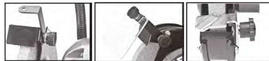
Рис. 2. Установка упоров и защитных экранов
