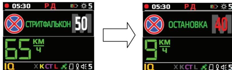
Следует отметить, что в случае движения в такой зоне с низкой скоростью (менее 10 км/ч), которая может быть свидетельством возможного намерения совершить остановку или припарковаться, прозвучит предупредительный звуковой сигнал. Отключить оповещения о контроле стоянки и остановки можно в пункте меню "Объекты контроля БД" -> КП -> Выкл.
