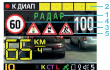
На окне оповещения об объекте базы радаров и камер демонстрируется следующая информация:
