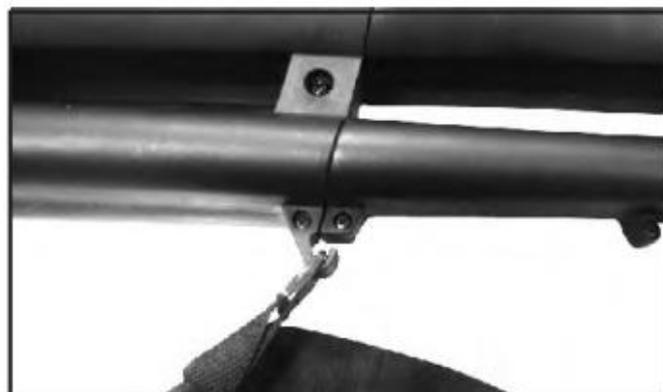
Закрепите крепление мешка на всасывающей трубе.
