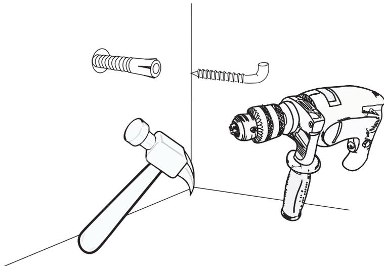
**ВНИМАНИЕ!** В комплектацию входит дюбель, предназначенный только для бетонной и кирпичной стен. Для гипсокартонной стены дюбеля подобрать самостоятельно, а так же заложить усиленный каркас для правильного распределения нагрузки изделия.
