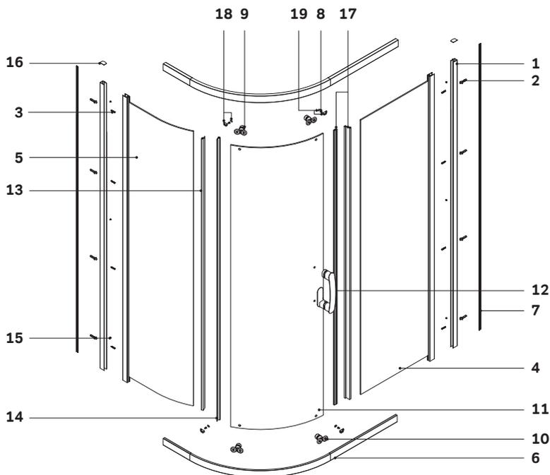
Gehäuse konfiguration / Enclosure configuration / Комплектация ограждения 120x80
