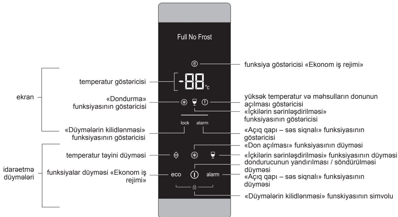
Şəkil 3 – İdarəetmə paneli
