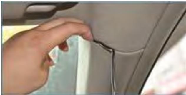
3. Спрячьте провод питания между швами внутренней обшивки автомобиля.
