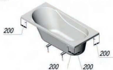
Рисунок 6 – крепление ванны к стене
