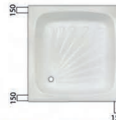
Рисунок 3 – крепление поддона к стене
