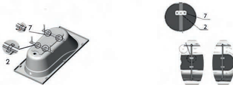
Рисунок 5 – фиксация ножек ванны
